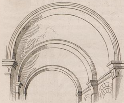
Fig. 158. Tonnengewölbe (aus E. Förster's Vorschule).
