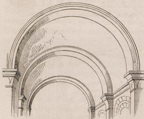
Fig. 158. Tonnengewölbe (aus E. Förster's Vorschule).
