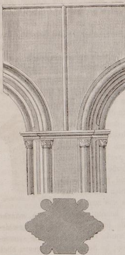
Pfeiler und Bogenanfang zu Thalbürgel.
