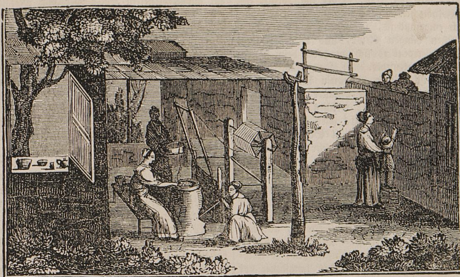
Das Abhaspeln der Seide zu einfachen Seidenfäden. Der Abhaspeler, welcher das doppelte Geschäft des Drehens und Unterhaltens des Feuers versteht, übt in dieser Abbildung letzteres aus.
