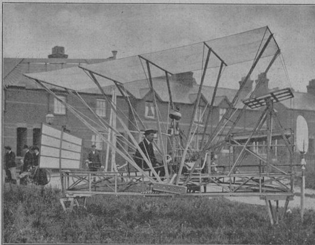
Ein neuartiger Aeroplan mit verstellbarem Segeldach als Windsfang: Der englische Aviatiker Fairbrother im Begriff, mit der von ihm konstruierten Flugmaschine einen Aufstieg zu unternehmen.
