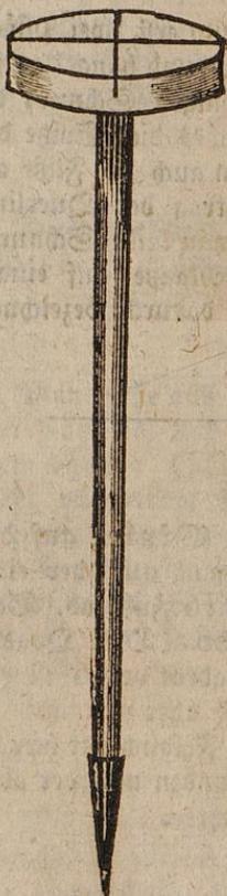
Da es sehr oft vorkommt auf dem Felde rechte Winkel zu ziehen, so bedient man sich dazu des hierneben abgebildeten sehr einfachen Werkzeugs welches man ein Winkelkreuz nennet. Man säget nemlich in eine hölzerne Scheibe zwei Einschnitte die sich rechtwinklich durchkreuzen, und befestiget diese Scheibe auf einem etwa 4 Fuß hohen Stock, welcher unten mit Eisen beschlagen ist (einen eisernen Schuh hat.)
