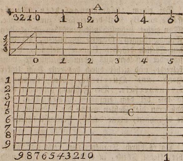
Ein einfacher Maasstab, wie A, besteht aus einer geraden Linie, worauf man eine Anzahl gleicher Theile abgestochen und mit Ziffern bezeichnet hat.
