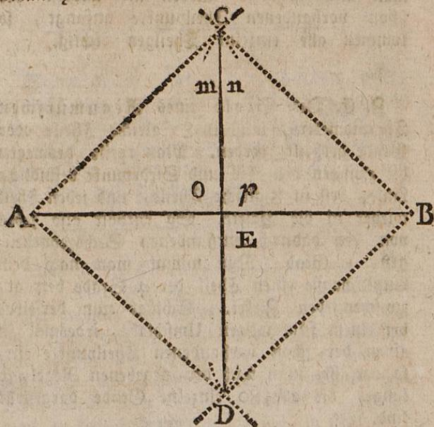
Man mache mit gleichbleibender Gröfzung des Zirkels, aus den Endpunkten der Linie  $AB$ , über und unter derselben, die Kreuzschnitte  $C$  und  $D$ ; an die Durchschnittspunkte lege man ein Linial, und ziehe die Linie  $CD$ . Diese wird die Linie  $AB$ , in dem Punkte  $E$  dergestalt durchschneiden, daß  $AE = EB$  wird.
