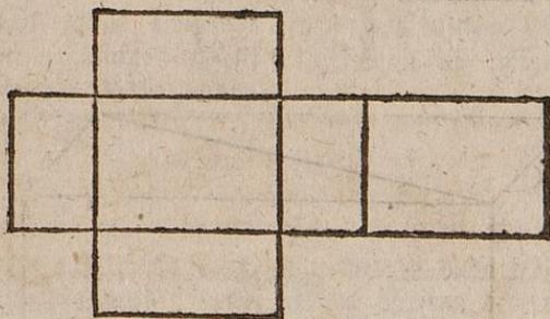
Ein Netz das aus sechs Rectangeln besteht, die so geordnet sind, wie obenstehende Figur zeigt, giebt einen Körper, den man ein Parallelopipedon nennet.
