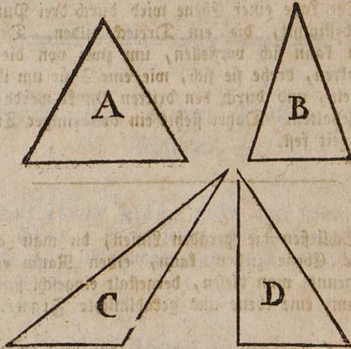
Sind alle Seiten und alle Winkel gleich, wie im Dreieck A, so heißt es ein gleichseitiges (oder auch ein gleichwinkliches.) Sind nur zwei Seiten einander gleich, wie in B, so heißt es ein gleichschenkeliges und ist keine Seite der andern gleich, wie in C, ein ungleichseitiges Dreieck.
