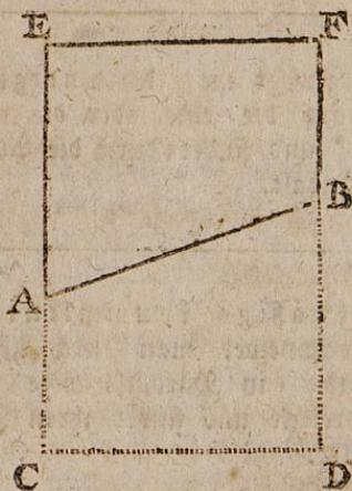
Denn wenn man die Seiten AC und BD des Paralleltrapezes ABCD aufwärts verlängert, und dann AC aus B in F und BD aus A in E trägt und die Linie EF zieht, so entstehet ein Rectangulum EFGD, welches
