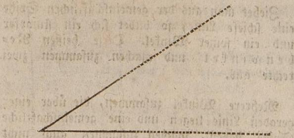
Auf die Länge oder Kürze der Schenkel, kommt es bei einem Winkel nicht an, sondern blos auf die Neigung oder Richtung, unter welcher sie zusammenstoßen. Denn man kann sich dieselben, nach obenstehender Figur, sowohl verlängert als verkürzt vorstellen, ohne daß der Winkel selbst eine Aenderung erleidet.
