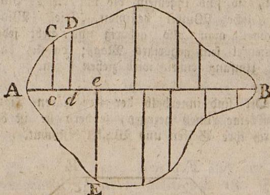
Irreguläre krumme Figuren, bestimmt und zeichnet man durch sogenannte Abscissen und Semiordinaten. Man ziehet nemlich eine gerade Linie  $AB$  dadurch. Diese nennt man die Normallinie. (oder Abscissenlinie) Auf diese Linie ziehet man aus denjenigen Punkten des Umfangs, zwischen welche ein Stück fällt das noch ziemlich gerade ist, Lotthlinien, wie  $Cc$ ,  $Dd$ ,  $Ee$  u. s. w. Diese heißen Semiordinaten. Die dadurch
