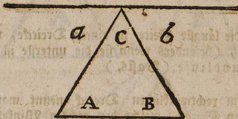
Denn man gedanke sich durch die obere Spitze, eine Parallele mit der Grundlinie gezogen, so entstehen Wechselwinkel, von welchen der Winkel  $a = A$  und der Winkel  $b = B$  ist. Zwischen beiden liegt der Winkel C. Alle drei Winkel aber liegen auf einer geraden Linie. Folglich sind sie zusammen so groß wie zwei rechte.
