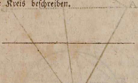
Wenn man sich auf dem Felde in einem Punkte befindet, aus welchem man drei andere Punkte erblickt, die schon auf einem Plane geometrisch construirt sind, so kann man, ( voraus gesetzt daß jene drei Punkte nicht mit diesem in dem Umfange eines Kreises liegen ) dasselbe in den Plan, nach folgendem Verfahren eintragen.
