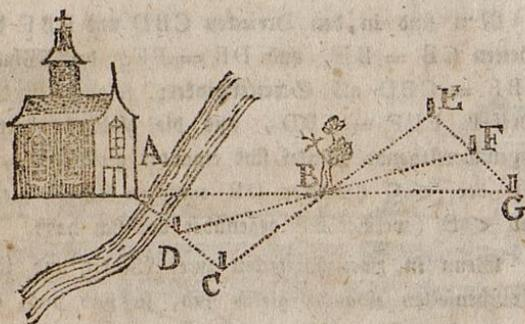
Man wähle einen beliebigen Standpunkt in C und stecke einen Stab ein; darauf gehe man nach A zu, so nahe als man kommen kann, und stecke den Stab D dergestalt ein, daß er mit A und C in gerader Linie steht.
