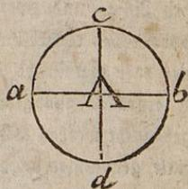
Die Scheibe A, welche von trockenem harten Holz gedreht wird, kann im Durchmesser 8 bis 12 Zoll messen, und ohngefähr 2 Zoll dick seyn.
