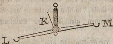
Eben so bleibt eine auf die Schwaige gezeichnete Linie n. o. beständig perpendicular oder winkelrecht auf der untern Linie P. Q., wenn letztere auch nicht horizontal gestellt wird, und folglich der Faden mit dem Bleisloth aus der Schwerlinie gebracht wird.
