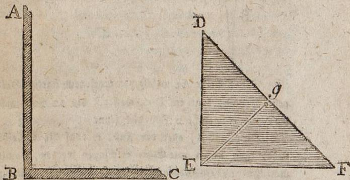
Ist eine Linie gegeben, auf welcher eine perpendikuläre errichtet werden soll; so legt man die Schärfe der Linie  $B C$  oder  $B A$  des Winkelmaßes, genau auf diese Linie und zwar so, daß der Punkt  $B$  auf dem gegebenen Punkte der Linie zu liegen kommt; die Perpendikularlinie kann alsdann nach Gefallen an dem andern Scheitel des Winkelhakens errichtet werden. Das Verfahren mit dem Dreieck ist dasselbe.
