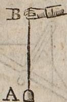
Eine solche Linie wird aber nur auf einer Horizontallinie oder Fläche und auf keiner andern senkrecht stehen; denn nur alsdenn, wenn der Faden mit dem Bleisloth an der Wasserwage in obige beschriebene freie Richtung gebracht wird, ist die untere Linie horizontal. s. S. 44.
