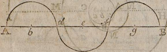
Sollen die Windungen der Schlangenlinie weniger sich krümmen: so setzt man die Mittelpunkte der Bogen ober: und unterwärts der Linie A B, in gleicher Entfernung von derselben, und mit derselben gleichlaufend. Setze den Zirkel in B, öffne ihn bis A, und ziehe bis d den Bogen A d. Dann setze den Zirkel, bey gleicher Eröffnung, in e, und ziehe von d nach f, den Bogen d f. Nachher setze den Zirkel in g, und ziehe aus f nach B, den Bogen f B.
