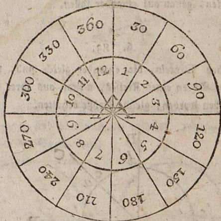
In einem jeden von diesen zwey Kreisbögen sind 12 gleiche Winkel um den Mittelpunkt A herum gelegt. Theilt man einen jeden dieser Winkel wieder in 30 gleiche Winkel: so erhält man 360 gleiche Winkel um diesen einzigen Mittelpunkt A; und einen jeden dieser Winkel nennt man einen Gradwinkel.
