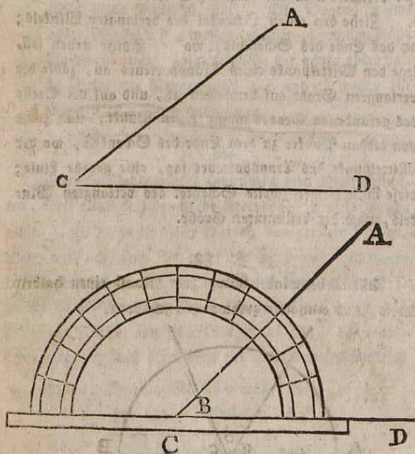
Die Größe eines gegebenen Winkels, z. B. den Winkel  $A C D$ , findet man, wenn der Mittelpunkt  $C$  des Transporteurs, an die Spitze des Winkels  $B$ , und der Halbmesser  $C D$  des Transporteurs, genau an den einen Winkelschenkel  $B D$  gelegt wird; denn nun zeigt der andere Schenkel  $C A$ , die Zahl der Grade, welche das Maas dieses Winkels sind, an.
