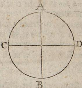
Alle gerade Linien, die man von einem Punkte der Kreislinie, bis zu einem andern Punkte derselben, durch den Mittelpunkt durchziehen oder sich denken kann, z. B. A B und C D heißen Durchmesser oder Diameter.
