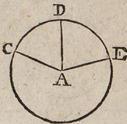
Jede Linie aber, die aus dem Mittelpunkte (A) nach jedem Punkte der Peripherie gezogen oder gedacht werden kann (z. B. C, D, E), heißt der Halbmesser oder Radius (die Speiche) des Zirkels, z. B. die Linien A E, A D, A C.
