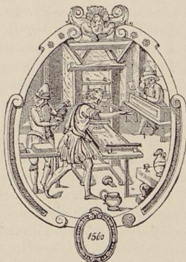
Nr. 2. Englische Buchdruckerpresse aus dem XVI. Jahrhundert. (Aus Johnsons Typographia .)
