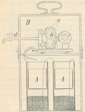
wie sie, nur in grösserer Form, in der Telegraphie verwendet werden, welche den Strom zum Betriebe des im oberen Teile des Kastens befindlichen Gebläses liefern. Letzteres ist folgendermassen eingerichtet: Ein Elektromagnet (mit a bezeichnet) und ein davorliegender Anker b mit Stromunterbrecher sind derartig angeordnet, dass die vibrierende Bewegung, in welche der Anker, wenn der Strom geschlossen ist, versetzt wird, dazu
