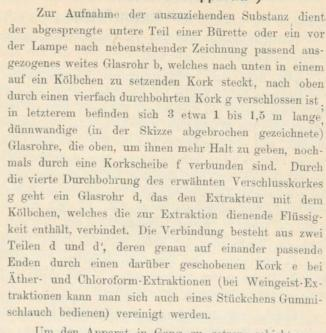
Um den Apparat in Gang zu setzen, schiebt man den zuletzt erwähnten Verbindungskork e nach oben oder unten, bis die Enden der beiden Glasröhrchen frei liegen, lüftet den das Dreiröhrensystem enthaltenden Kork g und nimmt ihn mit diesem ab. Das zur Aufnahme der Substanz dienende Rohr b verschliesst man nach unten, bei c, durch einen ungefähr 2 cm hohen und festgestopften Wattepfropfen und erprobt die hier notwendige Dichtigkeit des Pfropfens durch Übergiessen
