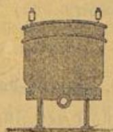
Für einzeln fahrende Lokomotiven auf der freien Bahnstrecke genügt eine roth leuchtende Laterne und bei Bewegung der Lokomotiven auf Stationen die Anbringung einer Laterne mit weißem Licht am Anfange der Lokomotive und am Ende des Tenders, bei Tenderlokomotiven an beiden Enden derselben.
