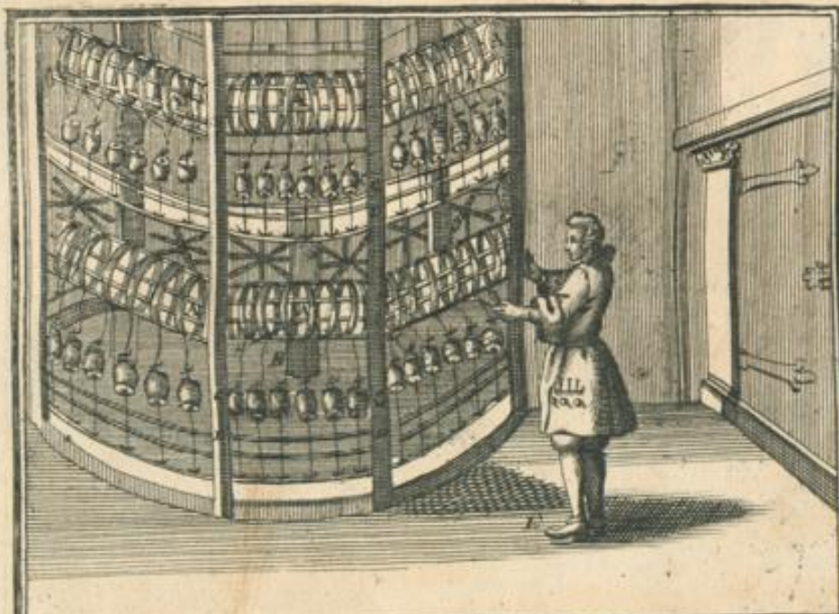
Machina oder großes Spinnrad in Italienische Filatorio genant worauf die Seiden einfach und doppelt gedrehet wird . 12.
