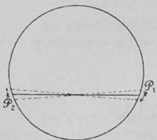
Die Bewegung erfolgt so, dass der eine Punkt sich stets ebenso tief unter, wie der andere sich über der Gleichgewichtslage befindet. Die Punkte vollführen Schwingungen um dieselbe, indem immer beide gleichzeitig sich in derselben Drehungsrichtung bewegen. Die halbe Dauer der Schwingungsperiode wird angegeben durch
