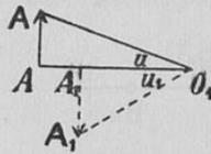
4. Ist  $A_1 A_1$  das Bild des Objekts  $A A$ , so sind  $A A$ , so sind, wenn das Auge sich in  $O_1$  befindet,  $\sphericalangle u_1 = A_1 O_1 A_1$  und  $\sphericalangle u = A O_1 A$  der künstliche und der natürliche Sehwinkel; die subjektive Vergrößerung ist daher
