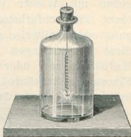
Fig. 19. Verbrennen einer Uhrfeder im Sauerstoff.
