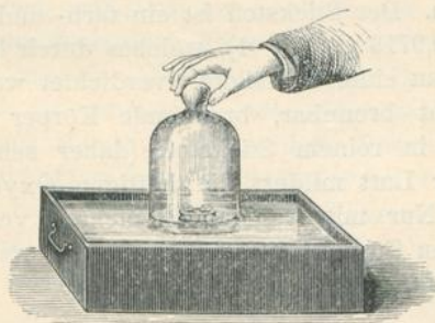
Fig. 26. Verbrennen von Phosphor unter einer Glasglocke.
