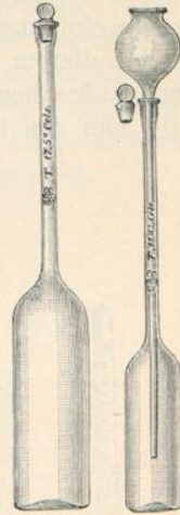
Abb. 2. Pyknometer nach Reischauer mit sehr engem Halse, mit eingeschlifftem Stöpsel und Fülltrichter.
