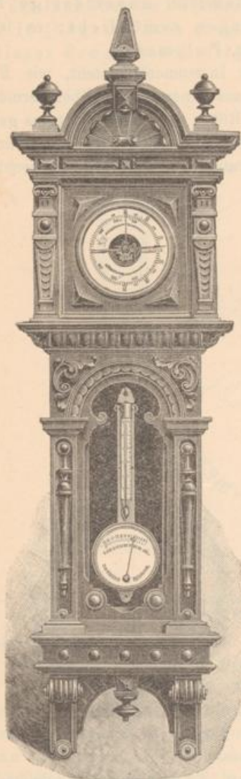
Fig. 67. Aneroidbarometer und Polymeter auf einer Holzfassung montiert (sog. meteorol. Observatorium).
