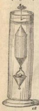
La densité ou pesanteur spécifique d'un corps est le rapport du poids au volume; c'est la quantité de matière sous un volume déterminé. Les corps pris ordinairement, comme terme de comparaison, sont l'eau distillée à son maximum de densité, c'est-à-dire à  $+4^{\circ}$  pour les solides et les liquides; et l'air atmosphérique, à  $0^{\circ}$  et  $0^{\text{m}},76$  de pression, pour les gaz.
