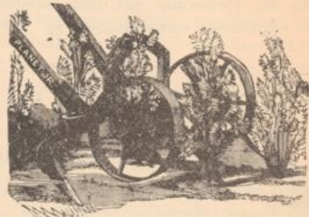
Fig. 31. Planet Jr. Doppelradhacke als Anhäufeler eingerichtet.
