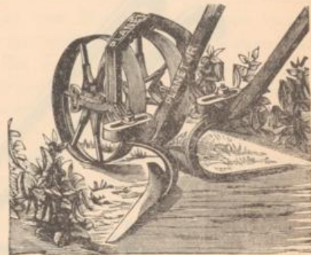
Fig. 32. Planet Jr. Doppelradhacke zwischen den Reihen arbeitend.
