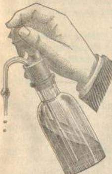
(cohésion, ténacité, viscosité du liquide); souvent aussi l'écoulement d'un liquide goutte par goutte se transforme, pendant le mesurage, en un filet continu. Dans le but d'obvier à ces inconvénients, de petits appareils, dits *compte-gouttes*, ont été successivement proposés par MM. Adrian, Dannecy, Salleron, Lebaigue, Limousin, Guichard, etc. (fig. 32 et 33).
