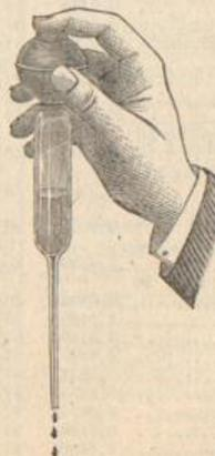
M. Limousin a construit sur le même principe que M. Lebaigue, un instrument qui donne aussi des gouttes d'un poids exact. Par sa disposition, il peut être facilement gradué et on peut l'utiliser comme pipette. (Fig. 35).
