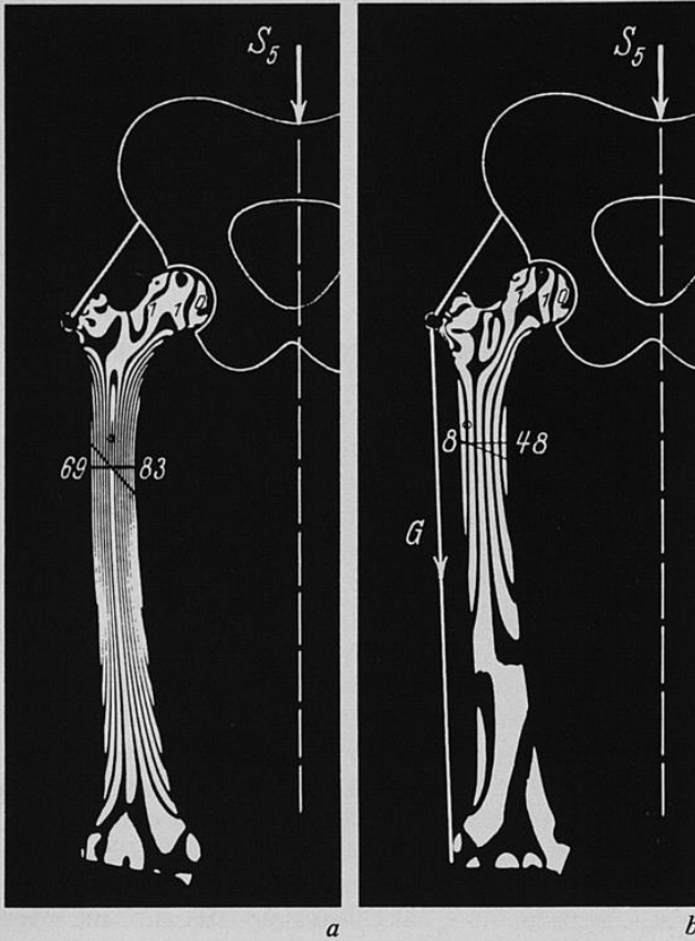
Abb. 22: Spannungsoptischer Versuch von F. PAUWELS zur Demonstration der entlastenden Wirkung des Tractus iliobtibialis auf den Femurschaft. a) Zahlreiche schwarze Linien (Isochromaten) zeigen eine hohe Beanspruchung durch das Körpergewicht S_5 an. b) Wie aus der verminderten Zahl der Isochromaten hervorgeht, bewirkt der Zug G eine wesentliche Herabsetzung der Beanspruchung. Die höchste Zugspannung an der lateralen Seite sinkt von 69 auf 8 kg/qcm. (Aus F. PAUWELS, 1958, I. c., Abb. 9)
