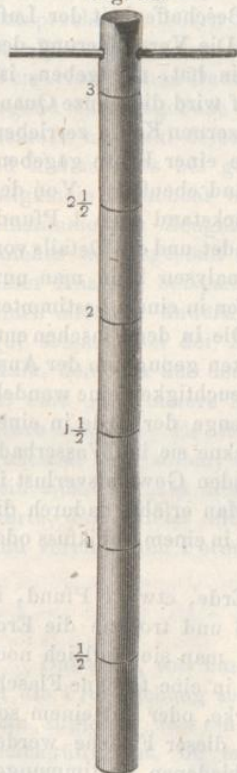
Probezieher für Dammerde.
