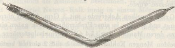
Absorptionsröhre für Kohlensäure.
