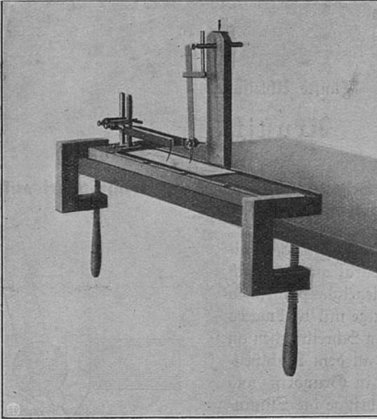
auch beide Schreibspitzen beim Anschlagen der Stimmgabel und beim Schwingenlassen des Pendels (Amplitude 1 cm) schreiben, d. h. die Lykopodiumschicht eben wegkratzen. Wenn bei diesen Vorversuchen die Lykopodiumschicht auf der Platte verbraucht sein sollte, ist die Spiegelglasplatte mit einem Tuche zu reinigen, neu einzufetten und einzustäuben.
