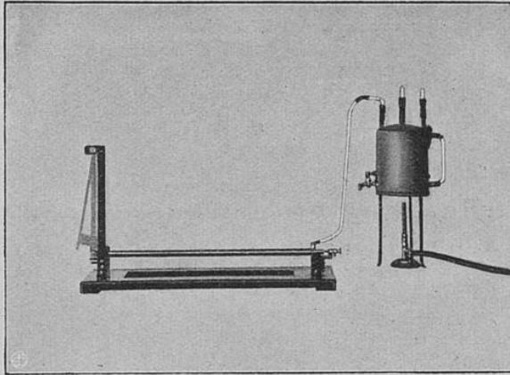
e) Nachdem man den Brenner unter dem Dampfkessel entfernt hat, lese man die jetzige Stellung  $n_2$  des Mikrometers ab und trage  $n_2$  in die Tabelle ein. Man berechne die Temperaturerhöhung des Stabes und seine Verlängerung. Tabelle ausfüllen.
