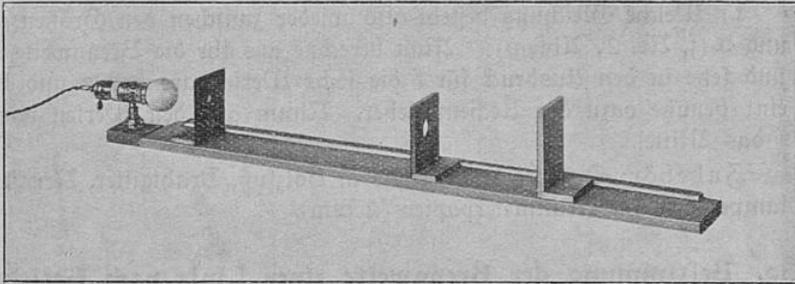
b) Man bringe den Schirm an das Ende der optischen Bank und nähere ihn so lange der Linse, bis man auf ihm ein deutliches Bild des Gegenstandes erblickt. Auf die Mitte des Bildes einstellen! Man lese den Ort des Bildes auf der optischen Bank ab und trage die Ablefung in die erste Zeile folgender Tabelle ein.
