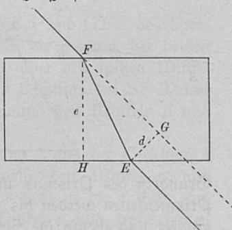
m) Zur Messung von  $e$  dient die Schublehre (größte Vorsicht!). Die erforderlichen Winkel messe man mit dem Winkelmesser und trage sämtliche zur Berechnung von  $d$  gemessenen Größen aus allen vier Figuren in die Tabelle ein. Berechne  $d$  viermal, trage auch diese berechneten Werte von  $d$  ein und vergleiche sie mit den beobachteten.
