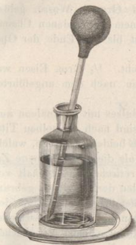
Schwefelsäureflasche mit Kautschuk- kugelpipette.
