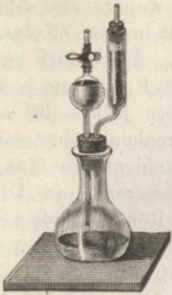
Compendiöser Kohlensäure- apparat des Verfassers.
