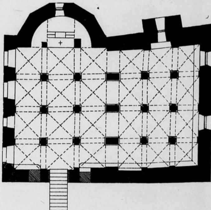
Fig. 15. Zülpich, Propsteikirche. Grundriss der Krypta. das Langhaus in den kräftigen Formen des rheinischen Übergangsstiles ist namentlich durch die Anlage vereinzelter früher Strebebogen von Interesse. Im einzelnen vgl. über den Bau ausführlich auf Grund der Untersuchungen vor den Herstellungsarbeiten Clemen und Renard, Die Kunstdenkmäler des Kreises Euskirchen, S. 205, Fig. 91—106, Taf. XII—XIV.
