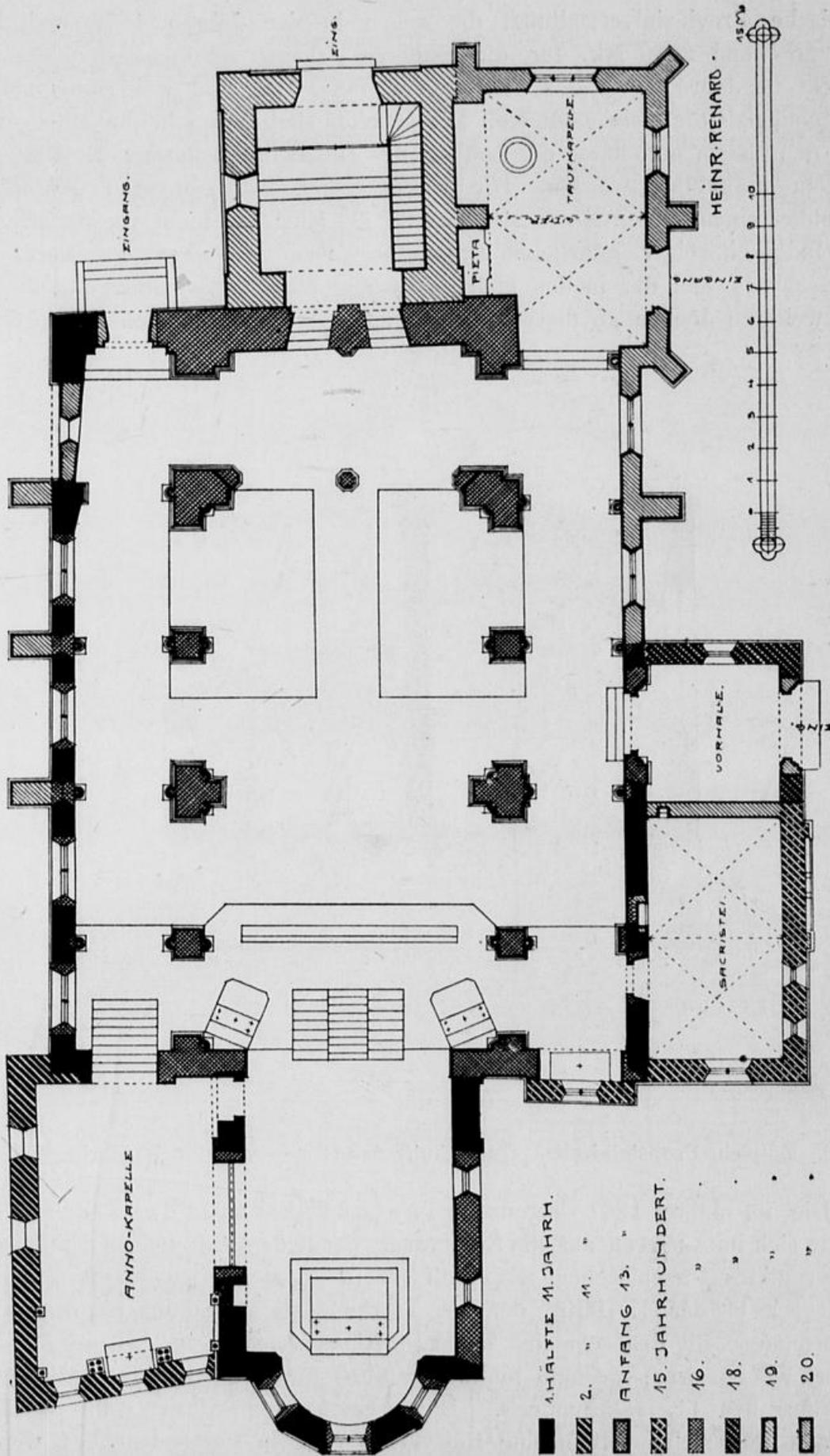
Fig. 17. Zülpich, Propsteikirche. Grundriss nach der Wiederherstellung mit Einzeichnung der im Verlauf der Arbeiten festgestellten Bauperioden.
