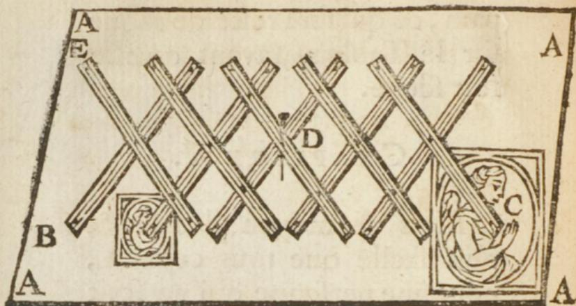
Ce petit ais marqué d'un A , doit être de sapin , couvert de toile , ou de quelque autre étoffe , parce qu'il faut attacher dessus ce que l'on copie , & le vélin sur quoi l'on veut copier. L'on y plante aussi le compas avec une grosse épingle par le bout du premier pied B , assez avant pour qu'il soit ferme , & pas tant que cela l'empêche de tourner aisément. Lorsqu'on veut tirer du grand au petit , l'on met son original vers le premier pied marqué par un C , & le vélin , ou le papier sur
