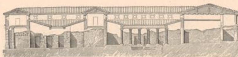
81] Haus des Panfa zu Pompeji; Längendurchschnitt.
