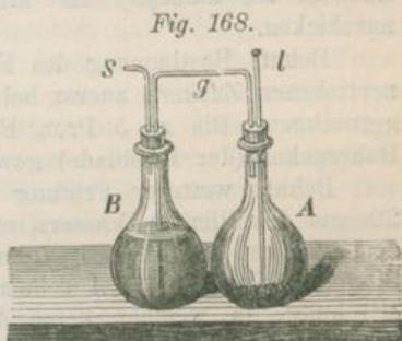
seitigung des Wachsstopfens das Kөлbchen *A*, um die von der Gährflüssigkeit zurückgehaltene Kohlensäure frei zu machen, entfernt den Rest Kohlensäure in dem Apparat durch Saugen an dem Rohr *S* und wägt den Apparat. Was er jetzt weniger wiegt, giebt mit 2,0454 multipliziert die Menge der vergohrenen Glykose oder des krystallisierten Milchsuckers, mit 1,9432 multipliziert die Menge des Rohrzuckers an. Das Resultat ist immer nur ein annäherndes.
