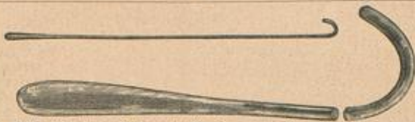
9-10. Einlegestab mit Messer zur Ausführung der Quätschenlich-Stickerei, Abb. 8. Siehe auch die Abb. 4-8 u. 11-12.
