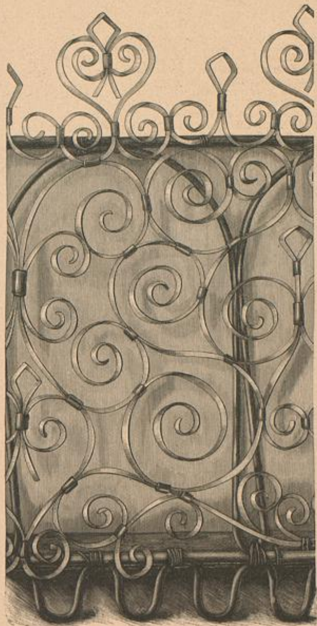
52. Klein-Eisenarbeit zum beweglichen Blumenbrett, Abb. 48 n. 48.
