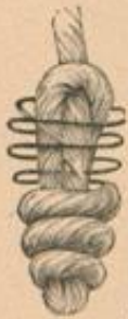
40. An- führung des Knotens zur Stimm- topf-Bekle- dung, Abb. 42. Siehe auch die Abb. 39 u. 41.
