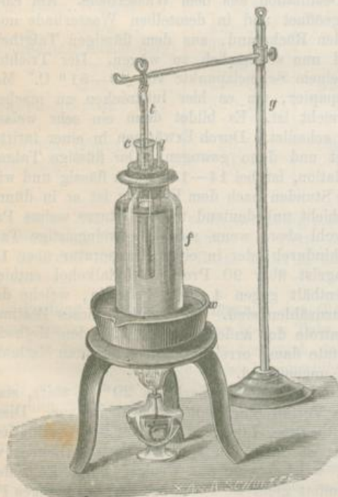
Fig. 153. Vorrichtung zur Erkennung des Erstarrungspunktes der Fettsäuren. w Wasserbad, f Glasgefäß mit Wasser, c Reagirylinder mit Fettsäure zu \frac{3}{4} angefüllt, t Thermometer, g Gestelle.
