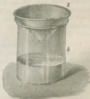
Fig. 160. Becherglas b mit einer Lösung des Fuselöls in Aether, zu \frac{1}{4} angefüllt. t Trichter ohne Abflussrohr als füllt. r Trichter dienend, welcher die Verdichtung des Aethers zulässt, die des Amylalkohols aber verhindert.
