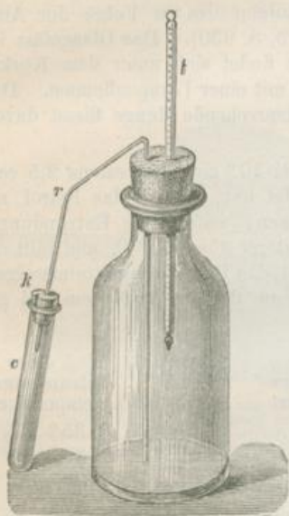
Fig. 123. Vorrichtung zur Prüfung des Petrols. t Thermometer, r Glasrohr, k Kork, c Reagir- cylinder.
