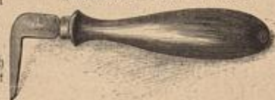
16. Messer zur Ausführung der durchbrochenen Federarbeit, Abb. 8 und 15.
