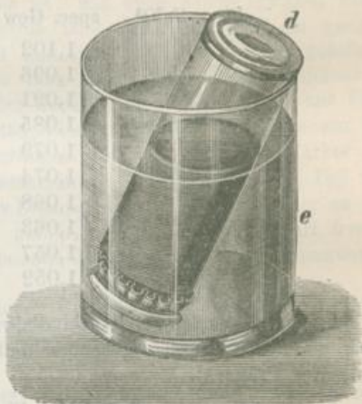
Fig. 65. Einfacher dialytischer Apparat. d Dialysator. e Exarysator.
