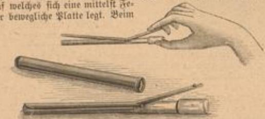
Ein kleiner Taschen-Brennapparat ist das Neueste, was die Industrie zur Bequemlichkeit der Damen geschaffen hat. Derselbe besteht aus einem vernickelten, mit einem chemischen Präparat gefüllten und an einem Griff befestigten Metallstäbchen, auf welches sich eine mittelst Feder bewegliche Platte legt. Beim
