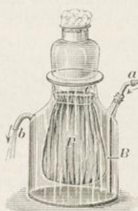
Proskauer'scher Beuteldialysator, welcher steriles Arbeiten ermöglicht und daher bei der Drogenanalyse, in der Bakteriologie und Serumforschung bevorzugt wird.
