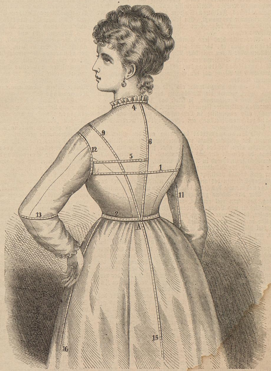
Fig. 2. Das Mass-System: Hintere Partie. 1. Oberweite. 2. Taillenweite. 4. Halsweite. 5. Rückenbreite. 6. Rückenlänge. 9. Schulterhöhe. 11. Armlänge. 12. Armloch-Umfang. 13. Ellbogenweite. 15. Hintere Rocklänge. 16. Rocklänge an der Seite.
