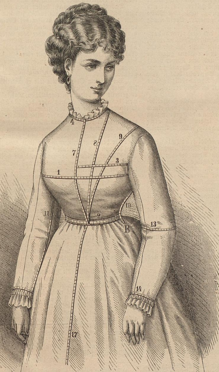
Fig. 1. Das Mass-System: Vordere Partie. 1. Oberweite. 2. Taillenweite 3. Brustbreite. 4. Halsweite. 7. Vorderhöhe. 8. Vorderlänge. 9. Schulterhöhe. 10. Seitenlänge. 11. Armlänge. 13. Ellbogenweite. 14. Handweite. 17. Vordere Rocklänge.
