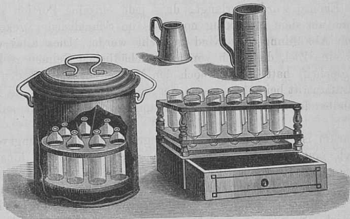
Soxhlet's Apparat zeigt das Wasserbad mit dem Blecheinsatz. Das Messurgefäss hat bei den Originalapparaten einen Schnabel zum Ausgiessen.
