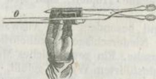
einer dünnen Platte schneidet, über das Glasrohr *o*, wofür es bestimmt ist, und schneidet mit einem Schnitte die überragenden Ränder ab und drückt die frischen Schnittflächen sogleich aneinander. Zum Festbinden des Cautschuckrohres auf den Glasröhren wendet man gedrehte
