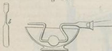
ihn nicht mittelst einer Caoutschukröhre mit der Retorte verbinden, so wird ein Stück einer weitem Glasröhre angelöthet, in welches man den Hals der Retorte mittelst eines durchbohrten Korkes einpasst. Man setzt den Apparat so in eine kaltmachende Mischung, dass nebst der
