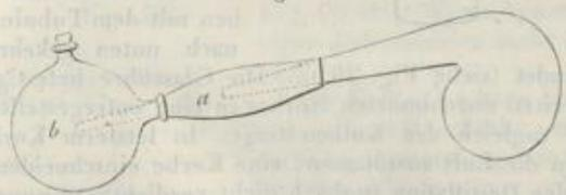
Man steckt den Hals der Retorte so weit in den Kolben, dass die Mündung des Halses sich in dem Bauche des Kolbens
