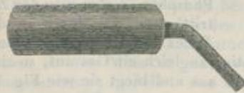
einfeilen (Fig. 44). Zur Destillation kleiner Quantitäten Quecksilber kann man auch einen weiten gebogenen Flintenlauf gebrauchen, dessen Zündloch man vernagelt. Man setzt denselben, so wie die Quecksilberflasche, geneigt in's freie Feuer, damit
