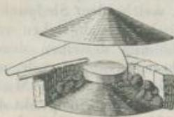
Kohlen (Fig. 31). Den Hals der Retorte unterstützt man durch ein Ziegelstück und wählt eine Vorlage von sehr dünnem Glas, denn solche von dickem Glas zerspringen, wenn die ersten Tropfen der noch sehr heißen Schwefelsäure hineinfallen. Alle Destillationen werden sehr beschleunigt, wenn man die Abkühlung des Retortengewölbes durch Luftzug, wodurch auch sehr heiß gewordene Retorten springen könnten, verhindert. Man erreicht dies durch Bedecken mit Hauben
