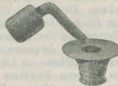
wie die Quecksilberflaschen mit eingefeiltem Flintenlauf im Großen, und werden in einem kleinen Gebläseofen erhitzt. Als Vorlage stellt man einen eisernen Mörser mit etwas Steinöl unter, in welches die Kaliumkugeln aus dem Flintenlauf fallen, welcher etwas stark gereinigt seyn und etwa 4 — 6 Zoll von der Oberfläche des Steinöls entfernt bleiben muss. Damit
