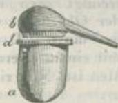
Tiegel, den man auch zu anderen Zwecken gebrauchen kann, mit einem etwas stärkern Ring am Rande. Der kleine mit einem angelötheten Halse versehene Eut *b* ist am untern sich etwas kegelförmig verengenden Rande ebenfalls von dickerem Platin getrieben und in den Tiegel luft-
