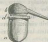
dicht eingeschmirgelt. Man kann denselben, wenn er nicht mehr schließt, von neuem mittelst feinen Schmirgels und Wasser einschleifen.
