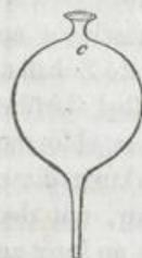
Es hat die Gestalt von beistehender Figur *c* und muß so klein wie möglich sein. Die Verbindung mit der Röhre *a*, in welcher die Verbrennung geschieht, wird durch eine Cautschuckröhre bewirkt. Es sammelt sich in diesem Gefäß das sich bildende Wasser, und damit Nichts davon durch die entweichenden Gase fortgeführt werden kann, leitet man diese
