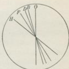
Fig. 36. Drehung der Schwingungsebene verschiedener Farben linear polarisierten Lichtes beim Durchgang durch eine zirkularpolarisierende Platte mit Linksdrehung.
