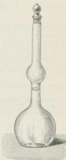
Abb. 25. Maßkolben mit kugelliger Ausbauchung über der Marke.
