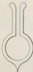
Abb. 40. Dewar'sches Gefäß für flüssige Luft.
