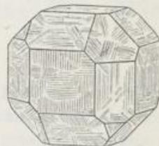
morph-rhombisch oder als monoklin gedeutet werden. Dann wird  $d = (100)$ ,  $a = (110)$ ,  $o = (101)$ ,  $o' = (10\bar{1})$ . S. Fig. 4 u. 5. In der Regel bestehen die Boracitkrystalle zum grösseren Theil aus dünnen Lamellen, die parallel einer Fläche  $d$  oder auch parallel einer Fläche  $o$  gestreckt sind, immer aber jene 6 Orientierungen zeigen, welche obigem Gesetze entsprechen. Fig. 6 zeigt an, in welcher Art die äusseren Flächen von jenen Lamellen geschnitten werden.
