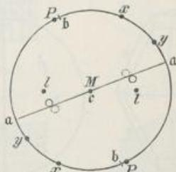
Der Borax, welcher die erste negative Mittellinie  $a$  parallel der Symmetrieaxe  $b$  und einen Axenwinkel von  $59^\circ 30'$  hat, liefert parallel der Längsfläche Platten, die im Konoskop ohne weiteres das Axenbild und dementsprechend gedrehte Dispersion zeigen. Fig.  $E$  und  $F$  auf Taf. II.
