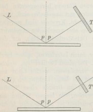
Die Einfallsebene, welche bei diesem Versuche vertical ist, wird Polarisations-ebene genannt. Man sagt demnach: wenn die Turmalinplatte so steht, dass ihre Hauptaxe zur Polarisations-ebene senkrecht ist, so lässt sie das polarisirte Licht hindurch, wenn aber ihre Hauptaxe zur Polarisations-ebene parallel ist, verlöscht sie den polarisirten Strahl, Fig. 306.
