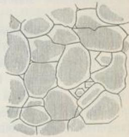
Durchschnitt einer Partie desselben Sandsteines. 4mal vergrößert. Die ursprünglichen trüben Quarzkörner sind in beiden Figuren durch eine Schraffirung angezeigt.
