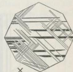
Verhalten zeigt. Im Orthoskop wird eine feine Zeichnung durch die schon früher, pag. 91, bezeichneten Lamellen parallel *M* hervorgebracht, jedoch treten auch querlaufende Streifen auf, die oft eine gitterartige Zeichnung veranlassen.
