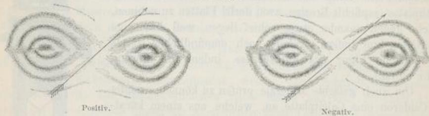
Auch mit Hilfe eines Gypsblättchens, welches als Polarisationsfarbe Roth I. Ordnung zeigt, und an welchem man die Lage der Auslöschungsrichtungen angemerkt hat, lässt sich die Bestimmung leicht und bequem ausführen. Nach Einschiebung der Gypsplatte in der Diagonalstellung erscheinen die vier Quadranten des Interferenzbildes um den Mittelpunkt herum abwechselnd blau und gelb gefärbt. Das Verhalten der optisch positiven und der optisch negativen Platten ist wieder um  $90^\circ$  verschieden.
