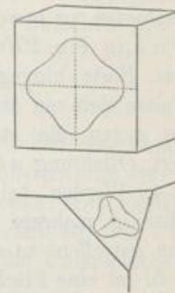
Das Steinsalz hat vollkommene Spaltbarkeit parallel den Würfelflächen. Demnach ist die Härtefigur auf diesen Flächen vierlappig, indem die Maxima der Härte den Diagonalen parallel sind, Fig. 274. Schleift man eine Oktaëderfläche an, so zeigt sich auf dieser dreieckigen Fläche die Härte am grössten beim Ritzen gegen die Würfelmanten zu, in entgegengesetzter Richtung am geringsten.
