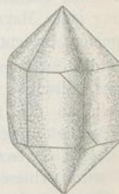
gibt das Verhalten eines einfachen Quarzkrystalles unter denselben Umständen an. Die Kanten, an denen die Trapezflächen und Rhombenflächen auftreten, werden beim Abkühlen negativ, die damit abwechselnden positiv elektrisch. Da jedoch die Mehrzahl der Quarzkrystalle aus mehreren Individuen besteht, so ergeben solche Krystalle nach dem Bestäuben oft bunte Zeichnungen. Fig. 377 liefert das Bild eines bestäubten Boracitkrystalles. Die Ecken mit den grösseren, glatteren Flächen
