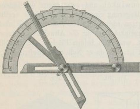
Für beiläufige Messungen an grossen Krystallen dient das Anlege-Goniometer oder Contact-Goniometer, auch Hand-Goniometer genannt, Fig. 12, welches aus zwei scheerenartig in einem Punkte verbundenen Linealen oder Schienen, ferner aus einem getheilten Halbkreis besteht. Bei der Anwendung hat man darauf zu achten, dass die Ebene der Schienen auf der Kante senkrecht stehen müsse. Der Halbkreis ist entweder von den Schienen getrennt oder mit denselben fest verbunden. Die Genauigkeit, welche
