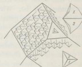
dagegen monosymmetrische Aetzhügel. Die Flächen beider haben aber, wie die Ziffern andeuten, dieselbe Lage, welche einem Trigondodekaëder entspricht.
