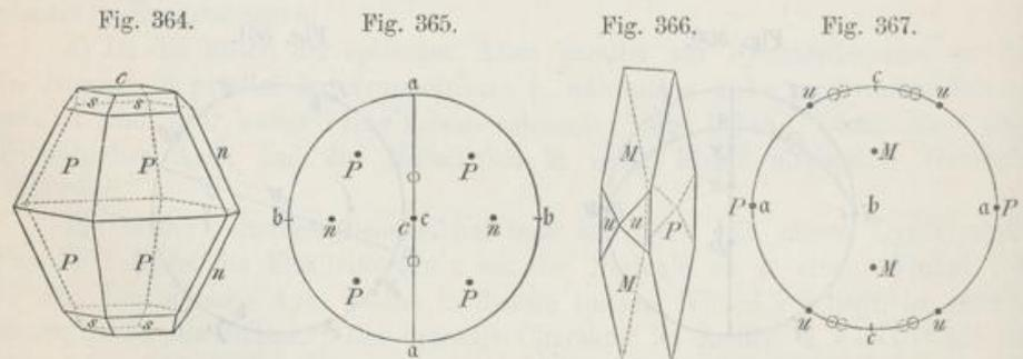
Tetragonales und hexagonales System. Die Symmetrie dieser Systeme erlaubt bloß die Existenz einer einzigen optischen Axe, welche der Hauptaxe parallel sein muss. In den Krystallen von positiver Doppelbrechung herrscht parallel zur Hauptaxe zugleich die kleinste Elasticität *c*, senkrecht dazu aber ringsum die grösste *a*. Bei den Krystallen von negativer Doppelbrechung ist es umgekehrt.
