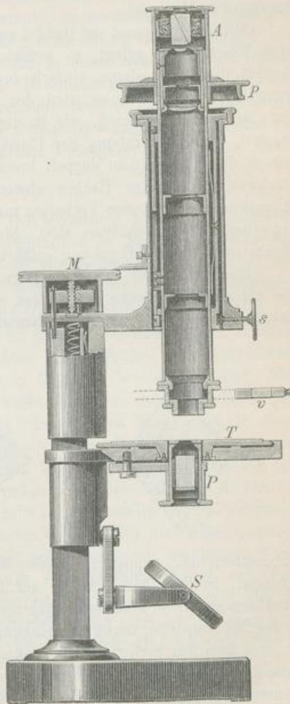
bleibt bei der Drehung des Tisches auch ein sehr kleines Krystallplättchen in der Mitte des Gesichtsfeldes. Eine Zugabe, von der später gesprochen wird, ist die kleine Quarzplatte *v*, welche oberhalb des Objectivlinsensystems, das hier nicht gezeichnet ist, horizontal eingeschoben wird. Von der Mikrometerschraube *M*, durch welche die Hebung und Senkung des Tubus genau bestimmt werden kann, ist schon
