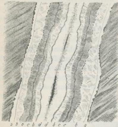
Symm. Mineralgang. *a* Quarz, *b* grüner Flusspath, *c* fleischrother Baryt, *d* weisser Kalkspath in gelbe Drusen ausgehend. Unter *a* und *c* etwas Blende, in *c* und unter *d* dünne Markasitschichten. Drei Prinzen Spat bei Freiberg nach Weissenbach.
