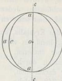
Wellenflächen eines positiven einaxigen Krystals, und zwar als innere Fläche ein gestrecktes Ellipsoid, als äussere eine Kugel, beide in der Achse  $c$  sich berührend, Fig. 350.
