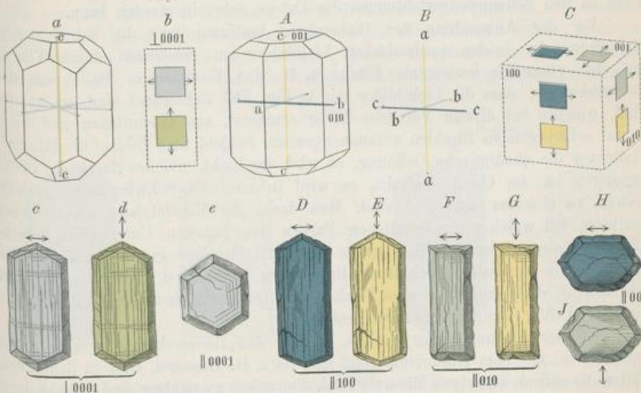
Prüft man Platten des genannten Cordierits in derselben Weise, so erhält man für jede der drei Platten, welche parallel zu den Endflächen geschnitten wurden, je zwei Farben. Ein Blick auf die Fig. 352 *A*, welche einen Krystall von Cordierit vorstellt und angibt, welche Farben den drei Hauptschwingungsrichtungen entsprechen, macht dies leicht verständlich. Die Platte
