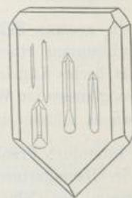
centration verschieden. Die Beobachtung der Aetzfiguren geschieht mittels des Mikroskopes entweder direct an der geätzten Fläche oder an Abdrücken, welche mittels Hausenblase oder Gelatine erhalten werden.
