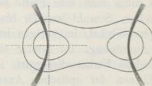
hat, und stellt in diesem zuerst das eine, dann das zweite Axenbild an dem Kreuzpunkte ein. Die zwischen beiden Einstellungen erfolgte Drehung wird an dem Limbus oder Vollkreis  $V$ , mit welchem die untersuchte Platte in Verbindung steht, abgelesen.
